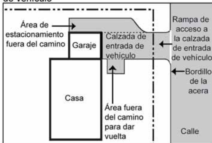
Calzada de entrada de vehículo residencial y rampa de acceso a la calzada de entrada de vehículo
